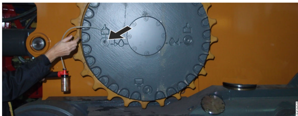
Рис. 406: Место отбора проб масла в редукторе ходовой части
