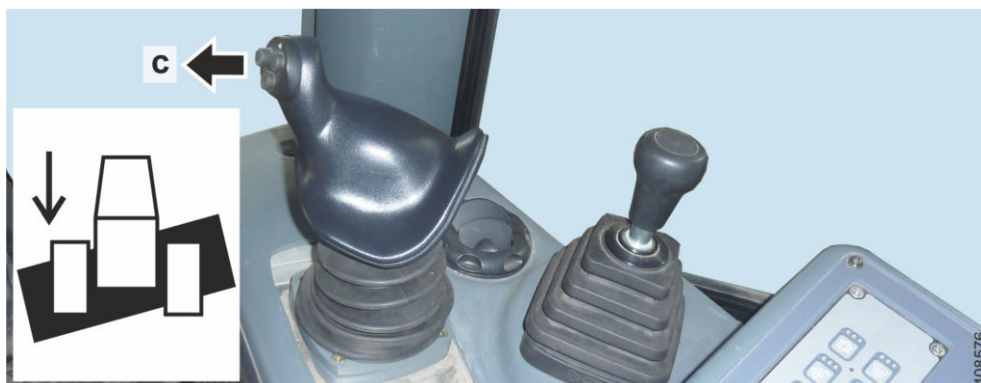
Рис. 265: Заглубление левой части отвала в грунт
