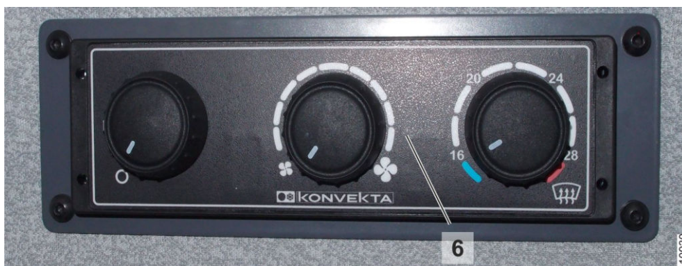
Рис. 51: Элементы управления системы отопления
