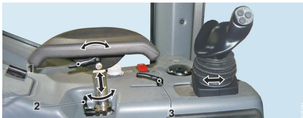
Рис. 181: Настройка подлокотников и рычагов управления
