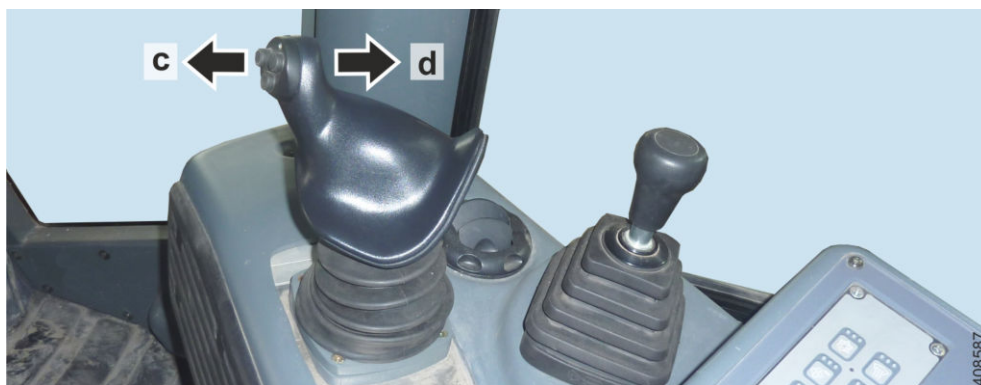
Рис. 270: Приведение в действие гидроцилиндра перекоса отвала
