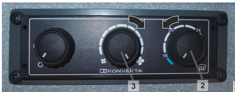
Рис. 193: Полная мощность кондиционера
