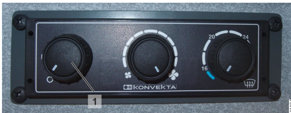
Рис. 189: Главный выключатель вентиляции
