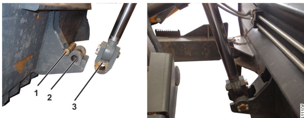
Рис. 327: Монтаж подъемного цилиндра
