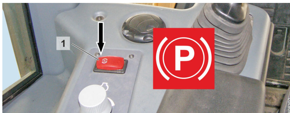
Рис. 409: Парковочный переключатель в положении парковки
