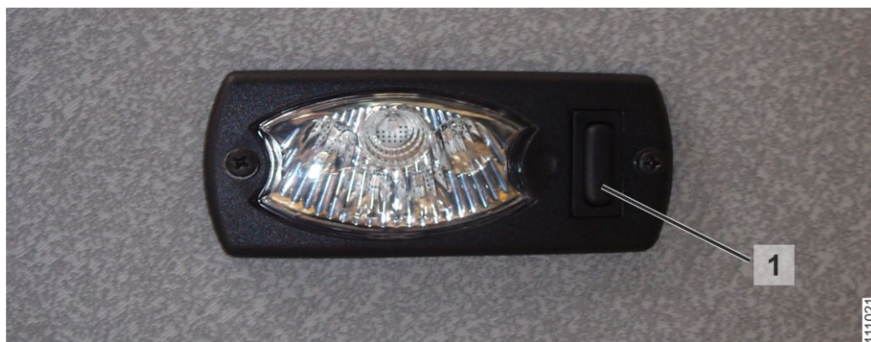
Рис. 195: Внутреннее освещение кабины
