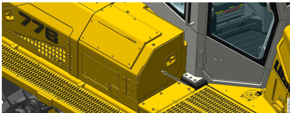
Рис. 453: Люк резервуара камеры контактного уплотнительного кольца
